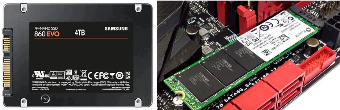
SSD-schijf: SATA (links) versus M2 (rechts)
